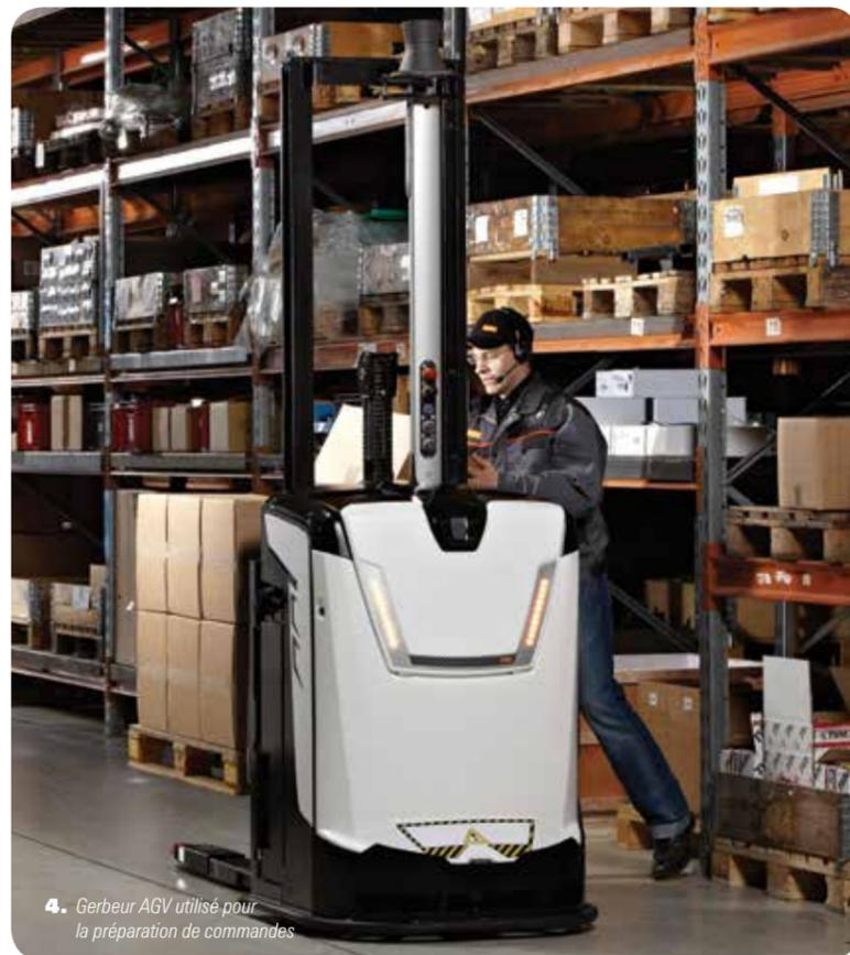
4. Gerbeur AGV utilisé pour la préparation de commandes
