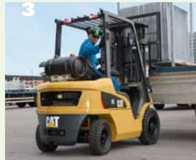
3. Les chariots Cat® Lift Trucks GP15N à 35N (fonctionnant au gaz) sont équipés de série d'un épurateur catalytique 3 voies. Il permet la réduction des substances dangereuses des composants toxiques des gaz d'échappement. Les composants dus à une mauvaise combustion, tels que les monoxydes de carbone (CO) et les hydrocarbures (HC), sont oxydés et transformés en dioxyde de carbone (CO<sub>2</sub>) et en eau (CO<sub>2</sub>).
